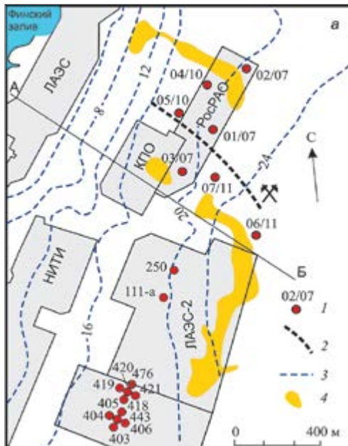
Рис. 1. (а) Расположение глубоких инженерно-геологических скважин на участках РосРАО и ЛАЭС-2 (1 – скважина и ее номер; 2 – трасса подземных горных выработок, 3 – гидроизогиписа верхнего водоносного комплекса; 4 – палеодолина). (б) Схематический геологический разрез по линии А–Б
